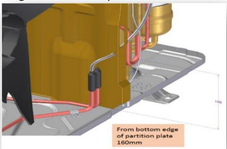
Hole diameter :  $\phi 15\text{mm}$
